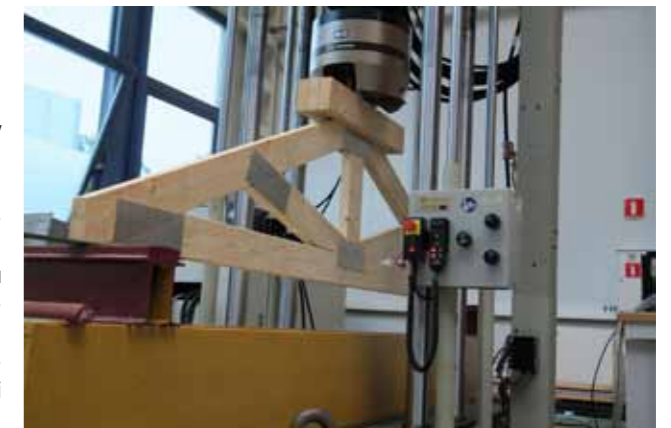
FOT 2. BADANIE JEDNEJ Z KRATOWNIC W LABORATORIUM IB UZ DOSTARCZONYCH PRZEZ PRZEDSIĘBIORSTWO BUDOWLANE WIĄZARY DACHOWE DAWID LISIEWICZ Z SULECHOWA
